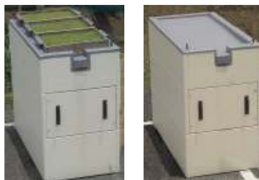
写真-1 モデルボックス設置状況 （左：緑化有り 右：緑化無し）
